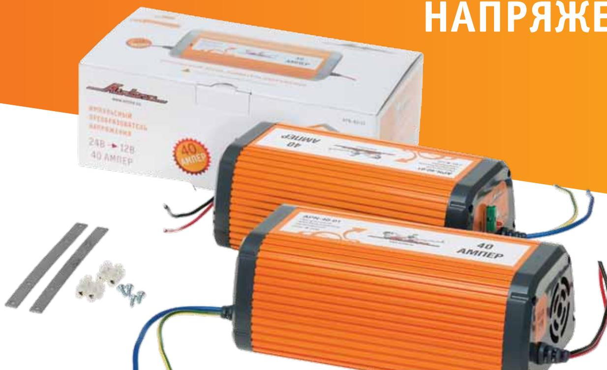
Импульсный преобразователь напряжения APN-40-01 служит для преобразования напряжения 19-35 В в напряжение 13 В. Предназначен для использования в автомобилях с напряжением бортовой сети 24 В. Высокий максимальный ток нагрузки (40А) позволяет подключать различные потребители тока, как маломощные (радар-детектор, ТВ-приемник, навигатор и др.), так и мощные (магнитола, холодильник, микроволновую печь, радиостанцию, подогрев сидений и т.д.) с напряжением питания 12 В.
