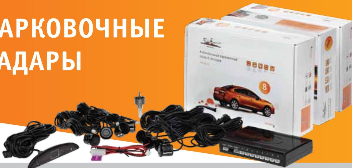
Парковочный радар (парктроник) — это система, облегчающая парковку автомобиля, движение его задним ходом в тёмное время суток и маневрирование в узких местах. Он сводит к минимуму риск повреждения кузова о приближающееся препятствие, так как своевременно предупреждает водителя о сокращающемся расстоянии до объекта.
